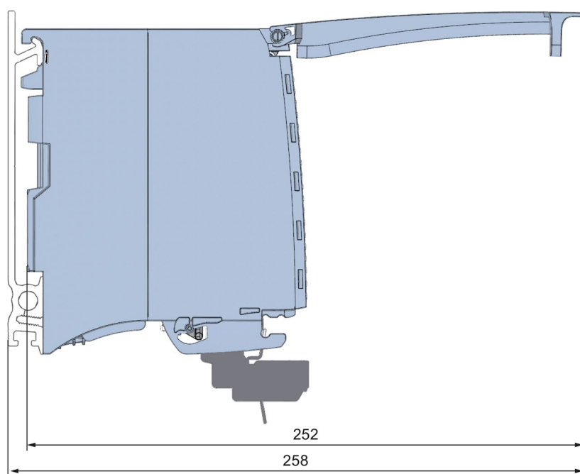
图 A-2 TM PosInput 2 模块的尺寸图，带开放式前面板的侧面图
